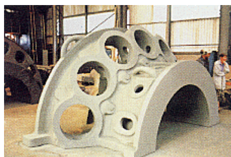
图7. 燃气轮机燃烧排气箱的一半 (威廉库克高科技公司特许刊登)
