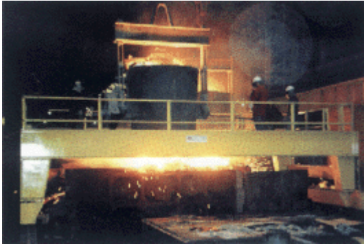
图4. 液态钢浇铸70t大型缸体
