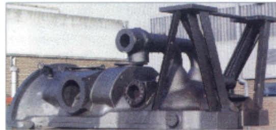
图5. 配有装配式淬取室和支撑的缸体
