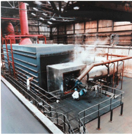
图8. 三井 - 巴布科克的大型燃烧器试验装置（三井 - 巴布科克能源有限公司特许刊登）
