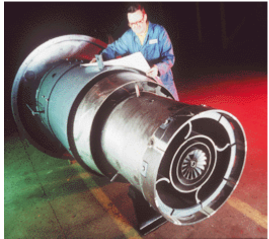
图9. 三井 - 巴布科克的低NO x 燃烧器（三井 - 巴布科克能源有限公司特许刊登）
