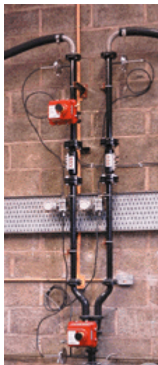
图31. 煤粉控制示范试验装置（EMC环境工程有限公司特许刊登）
